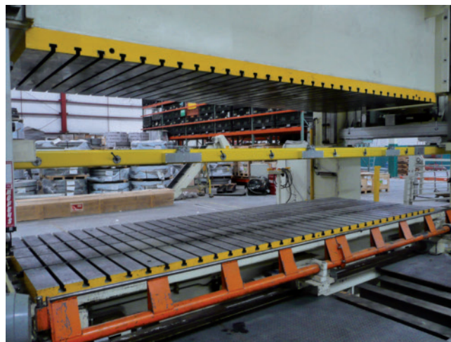
Gillet befindet sich gerade im Aufbau einer Transferanlage mit Greiferschienen aus dem Werkstoff CFK in Mexiko
