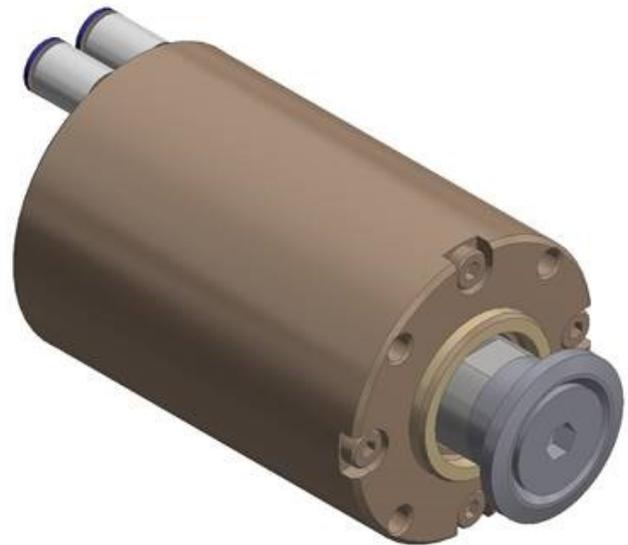
Der Axialspanner ist pneumatisch betätigt und erreicht Spannkraften von bis zu 4000 N. Der Spanner verriegelt mechanisch über Selbsthemmung und bleibt auch bei Druckverlust sicher gespannt. Ein weiterer Vorteil ist, dass mit 750 g der Spanner ein Leichtgewicht ist und auf der Greiferschienen außen Platz für sonstige Installationen lässt, Clean Design!
